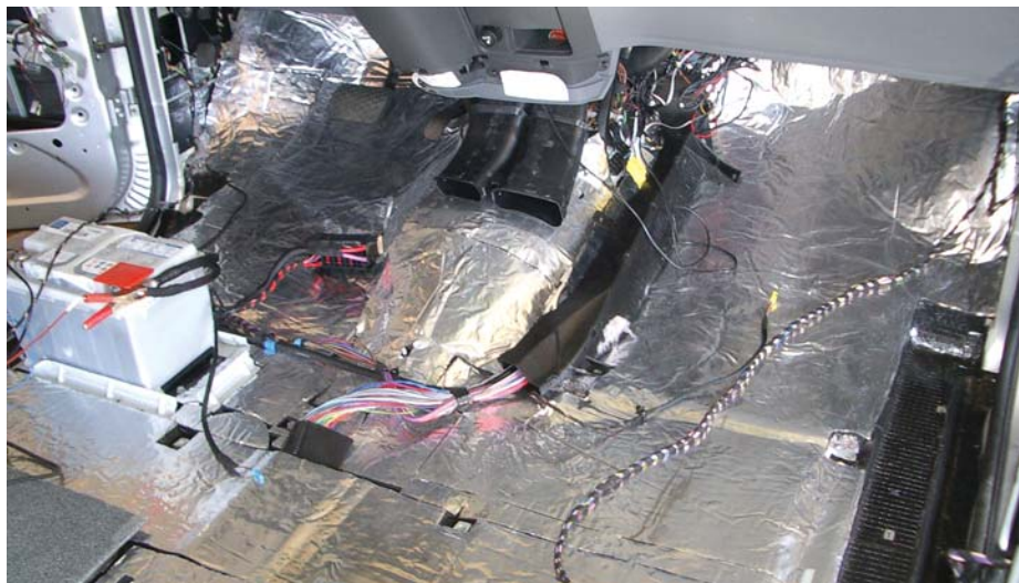
Siekiant efektyvaus triukšmų izoliavimo, transporto priemonėje reikia įkloti keletą sluoksnių skirtingų medžiagų ir kiek įmanoma sandariau bei plačiau uždengti automobilio saloną
