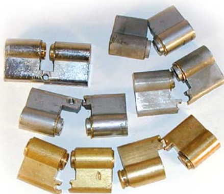
Europinio tipo cilindrai yra tvirtinami vienoje vietoje ir joje jie yra lengviausiai pažeidžiami
